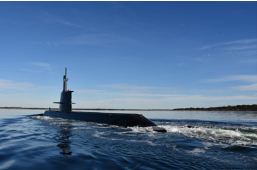
Ubåten HMS Gotland byggdes av Kockums och sjösattes 1992 och modifierades mellan 2016 och 2018, bland annat innebärande förlängning med två meter, nya stridsledningssystem och nya luftberoende Sterlingmotorer. Ubåtens tysta gång och smygegenskaper, kom att uppmärksammas i samövningar med amerikanska flottan som hyrde ubåten i början av 2000-talet. Foto Rebecka Sidnäs
