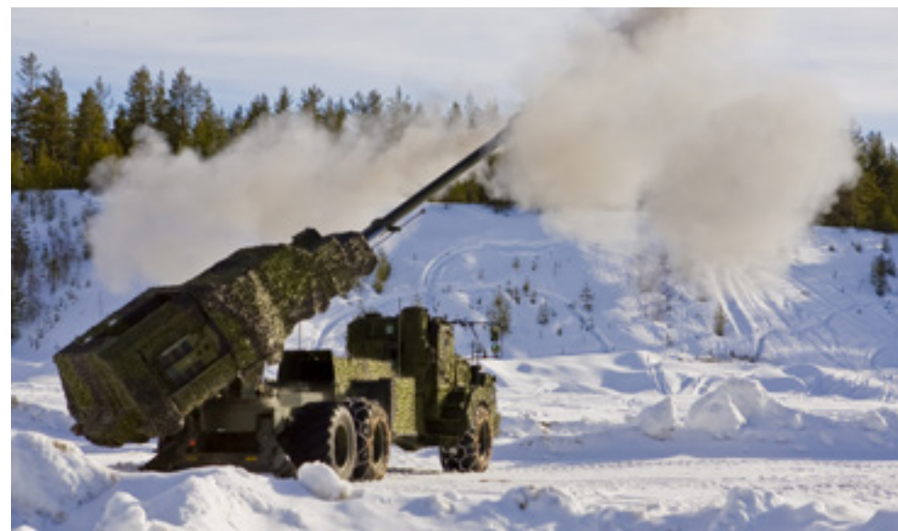
Artillerisystem O8, även benämnt Archer, är ett självgående artillerisystem som utvecklats för den svenska Försvarsmakten, med leveransbörjan 2013. Varje pjäs bemannas av fyra man. Projektilernas kaliber är 15,5 cm och räckvidden mellan 30 och 50 kilometer beroende på ammunitionstyp. Foto Försvarsmakten
